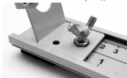
Фото 5. Крепление стойки к основанию
