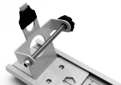
Фото 6. Уплотнитель (термоусадка) и длинные болты
